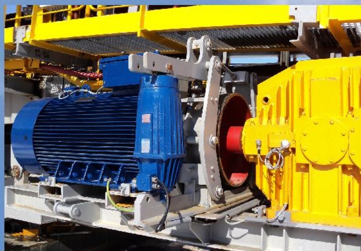
Установка электрогидравлического подъемника на приводной станции карьера «Граѓаница» Гацко Република Сербская
