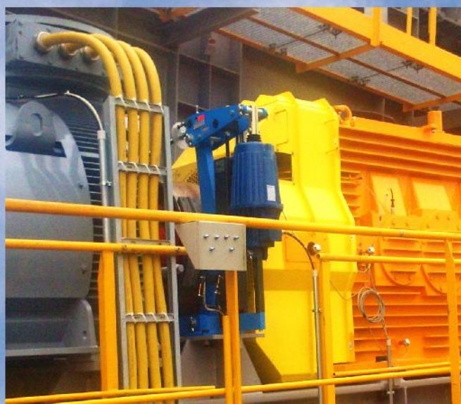
Электрогидравлический подъемник установлен на приводной станции карьера Дрмно, ТЕ Костолац - Сербия
